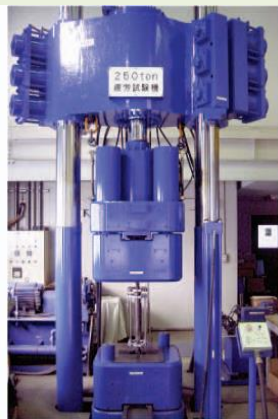
250 ton Fatigue testing machine
