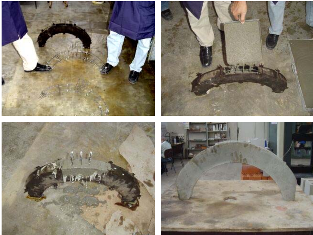
Figura 4 – Pé de mesa pré-moldado com argamassa auto-adensável
