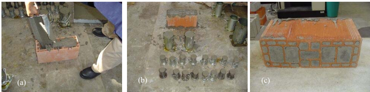
Figura 5 – (a) Preenchimento do tijolo cerâmico estrutural; (b) tijolo depois de preenchido e corpos-de-prova cilíndricos de 5cm x 10cm; (c) vista da outra face do tijolo preenchido após endurecido
