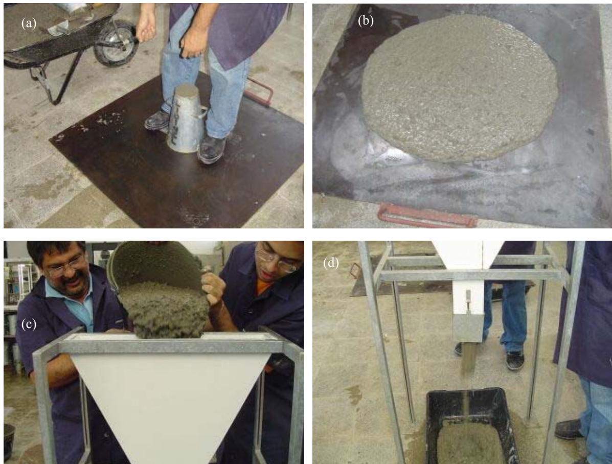
Figura 6 – Ensaio: (a,b) extensão de fluxo; (c,d) funil V
